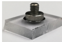
Abbildung 4.7: CAT-Prüfkörper: V2A-Prüfgewicht mit DELO-DUOPOX AD840 auf PC geklebt.
