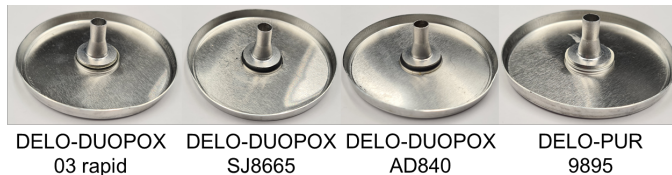
Abbildung 4.3: Verwendete Wechselplatten für die Messungen im Platte/Platte-Rheometer.
