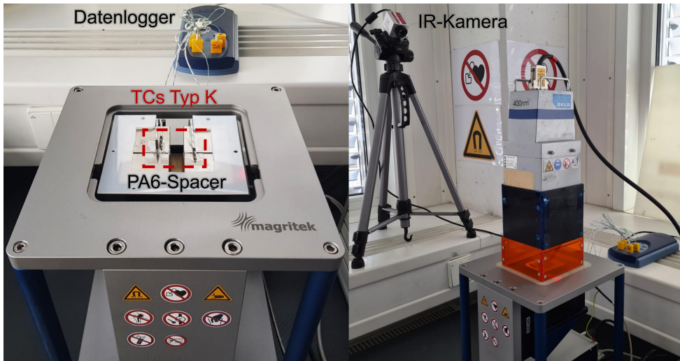
Abbildung 4.10: Temperaturüberwachung des uNMR-Messsystems. Links: Auf den Magneten angebrachte Typ K-TCs mit Spezialspacer zur thermischen Entkopplung, rechts: IR-Kamera zur Überwachung der OF-Temperatur von HF-Spule und Proben sowie Aufbau mit LED-Aushärtungslampe.
