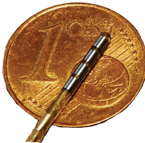
Eine Sensight-Elektrode mit einer Münze zum Größenvergleich. Bild: Medtronic
