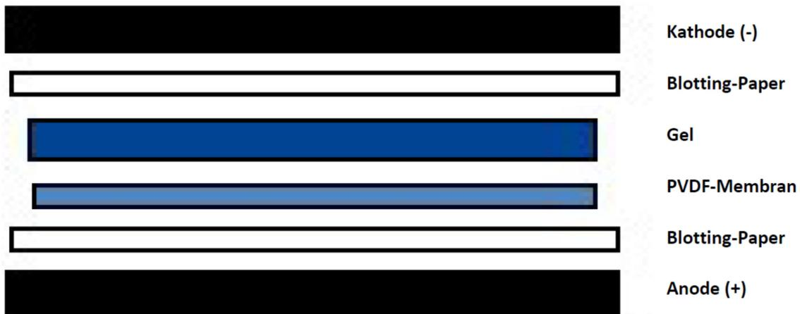
**Abbildung 10:** Schematischer Aufbau eines Semidry Western Blots (eigene Abbildung)
