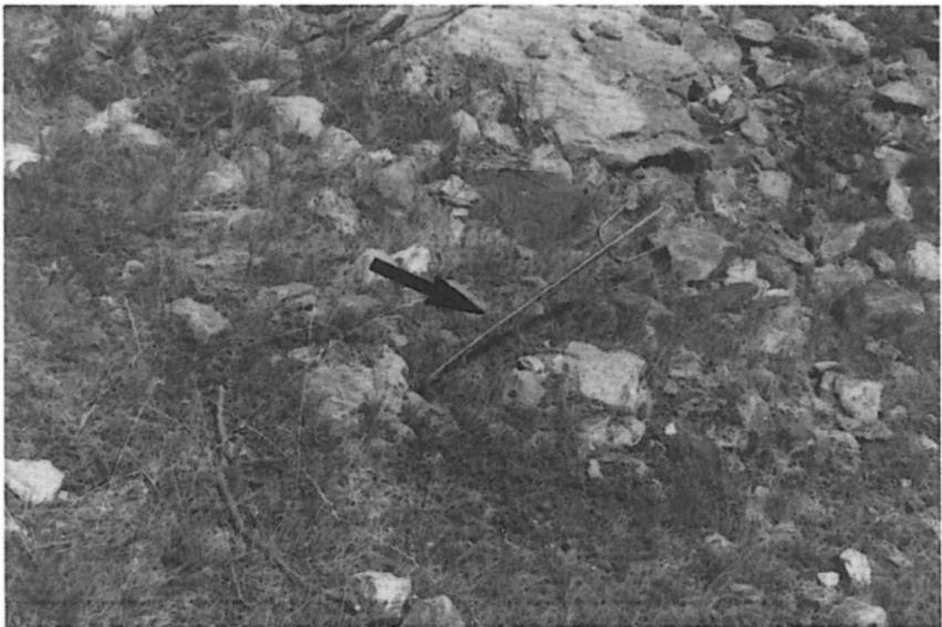
Abb. 90: Versuchshang 1991: Durch Grundlawinenabgang bzw. Steinschlag zerstörter Denudationspegel. Photo: Blätter 1991
