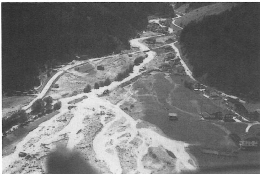
**Abb. 74:** Ruetz bei Schaller/Neustift nach dem Juli- Hochwasser 1987. Deutlich sind die Bachausuferungen im Bereich der Landesstraßenbrücke und zwei Damnbrüche zu sehen. Die ausgebrochene Ruetz, ging als „braided river“ nahezu auf voller Talbreite ab. Photo: Wildbach- und Lawinenverbauung Innsbruck, 1987
