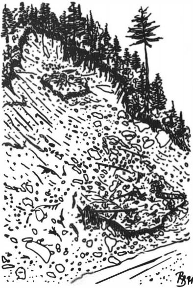
Abb. 95: Langental: Rotationsbruch am Einhang des Langeilbaches
