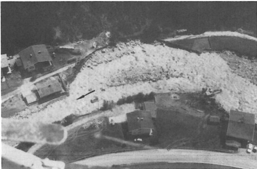
*Abb. 72: Lateralerosion innerhalb der Ortschaft Neustift/Schaller. Deutlich ist zu sehen, daß sich der Prallhang während des Hochwassers weiter talabwärts verlagerte. Photo: Wildbach- und Lawinenverbauung Innsbruck 1987*
