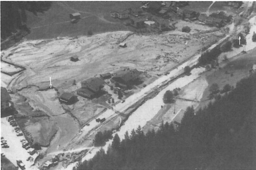
*Abb. 136: Krößbach nach dem Julihochwasser 1987. Die im Bereich Alt-Krößbach ausbrechende Ruetz (a) ging auf voller Talbreite ab, verwüstete den gesamten Tatboden und überflutete sämtliche Neubauten innerhalb der Aue. Dank freier Transportkapazität konnte die Ruetz, noch innerhalb des flachen Auebereiches erneut erodieren und Material aufnehmen (b).*
