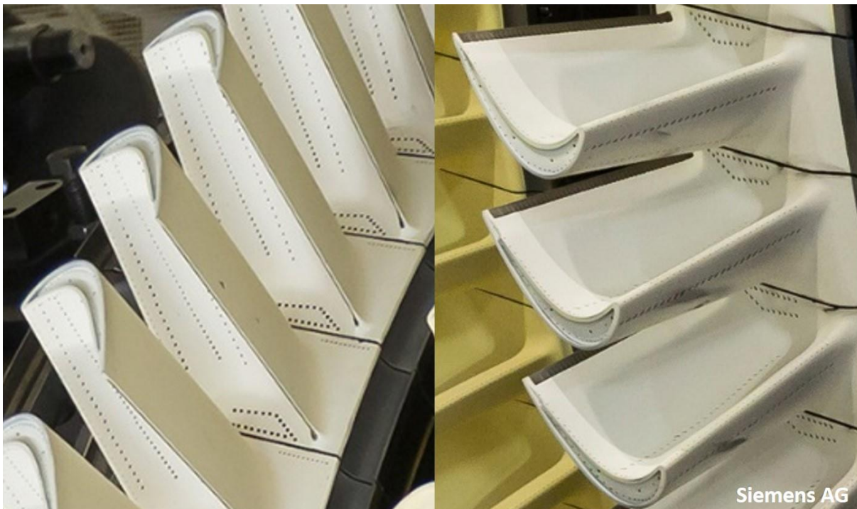
Abb. 2.13: Detailaufnahmen von Turbinenschaufeln mit keramischer Wärmedämmschicht aus der ersten Schaufelreihe einer modernen Gasturbine (rechts: Ansicht in Strömungsrichtung; links: Ansicht entgegen der Strömungsrichtung). Gut erkennbar sind die Auslassöffnungen der Filmkühlung im Frontbereich und an der Hinterkante der Schaufeln [88].
