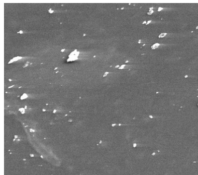
Abb. 98: REM-Aufnahme von 0.1% SIPERNAT® 22S mit DATEM bei 2 h Mischzeit (10000fache Vergrößerung)
