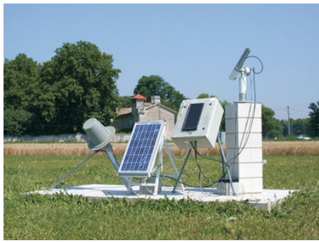
Abbildung 3.4: Sonnenphotometer des AERONET-Messnetzwerkes, Beispiel der Station bei Avignon, Südfrankreich [116]; Verlauf der AOT_{550} in Avignon, August 2003
