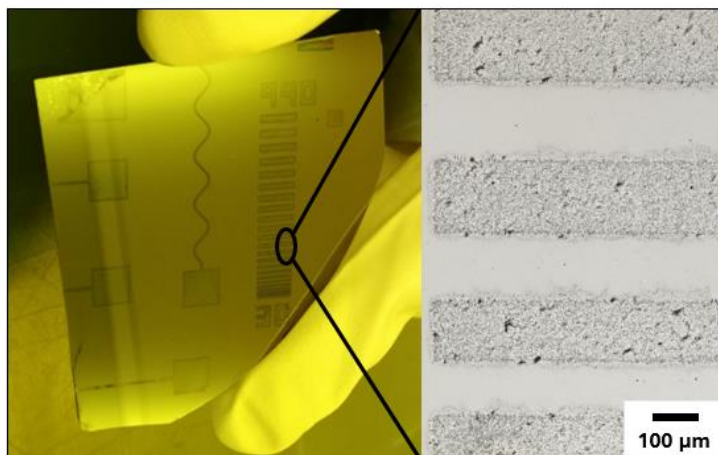
Abb. 5.5.4: Fotografie- und LSM-Aufnahme einer unpolaren methacrylat-funktionalisierten Silbernanodraht-Hybridpolymer-Kompositstruktur auf Si-Wafer als Substrat. LSM-Aufnahme zeigt einen Ausschnitt bei 10-facher Vergrößerung.
