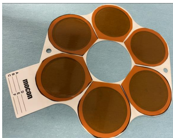
Abb. 4.3.1: Photographie eines Probenträgers für WVTR-Messungen mit PI-Folie als Referenzsubstrat.
