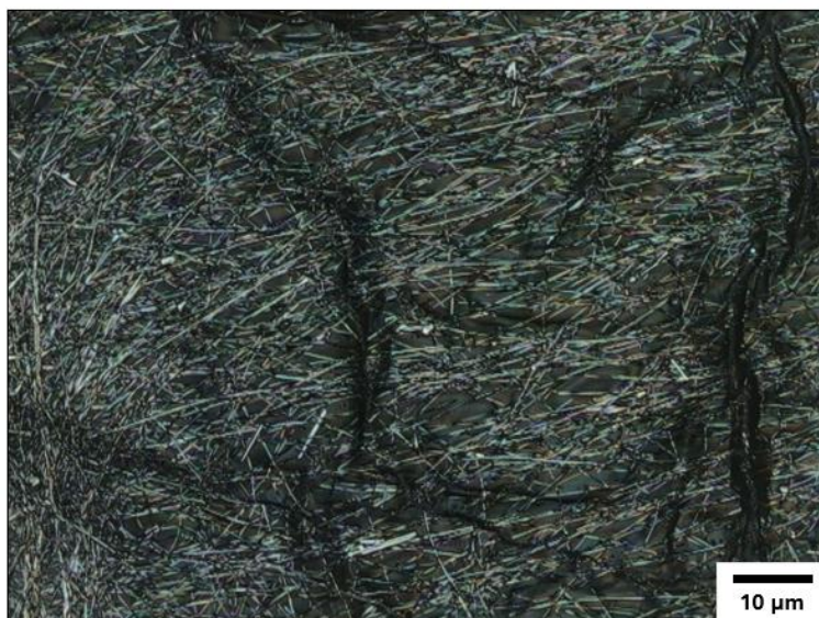
Abb. 5.4.14: LSM-Aufnahme einer unpolaren Silbernanodraht-Hybridpolymer-Kompositschicht bei 30 % Dehnung. Aufnahmen bei 150-facher Vergrößerung.
