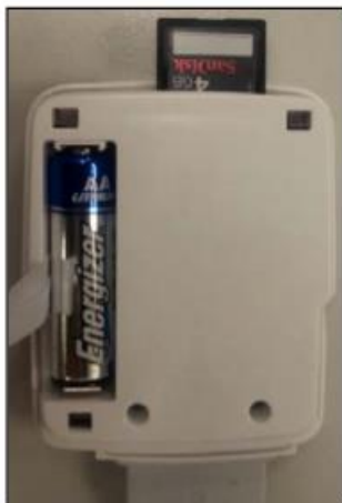
Abbildung 28 12-Kanal-EKG, Schiller Medilog FD12 Plus Speicherkarten und Batteriefach, aus Arbeitsanweisung, Version 1 vom 21.06.2013
