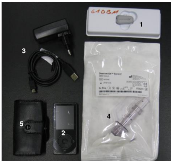
Abbildung 29 1 Sensor Dexcom G4 der Firma Dexcom; 2 Transmitter Dexcom der Firma Dexcom; 3 Ladekabel für Transmitter; 4 Applikator für Sensorhalterung; 5 Transmittertasche; aus Patientenleitfaden EFSD-Studie, Version 4 vom 28.01.2014
