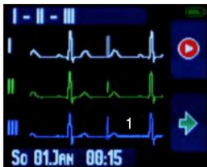
Abbildung 27 Displaydarstellung 12-Kanal-EKG, Schiller Medilog FD12 Plus zur Kontrolle der Ableitungsqualität, aus Arbeitsanweisung, Version 1 vom 21.06.2013
