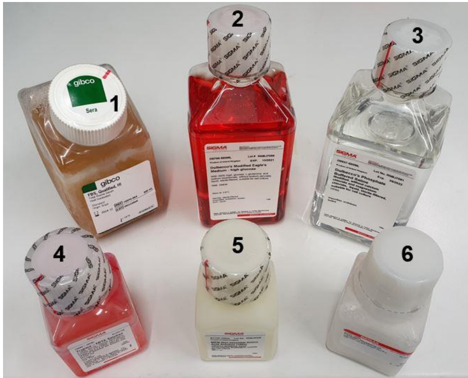
Abbildung 58 Überblick der Medien, Flüssigkeiten und Supplemente, die in der routinemäßigen CaCo-II-Zellkultur verwendet wurden. Zum Dulbecco's Modified Eagle Medium (DMEM, 2) wurden hitzeinaktiviertes fetales bovines Serum (FBS, 1), nicht-essentielle Aminosäuren (NEA, 5) und Penicillin-Streptomycin (PEST, 6) zugesetzt. Mittels Phosphate Buffered Saline (PBS, 3) wurden die Zellen beim Passagieren gewaschen und mit Trypsin-EDTA-Lösung (T/E, 4) vom Zellkulturflaschenboden abgelöst.
