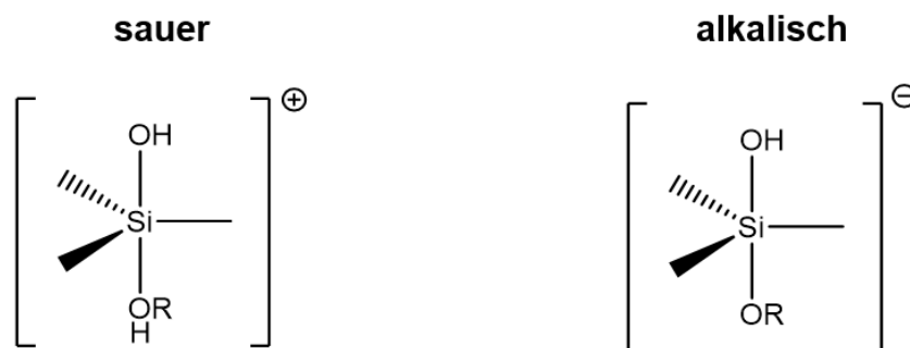
Abbildung 12: Pentagonale Übergangszustände der Hydrolyse beim Sol-Gel-Prozess mit R als Alkylgruppe.
