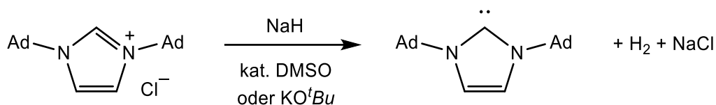
Abb. 1.2.1: Synthese von 1,3-Diadamantylimidazol-2-yliden (IAd) nach Arduengo et al. [107]
