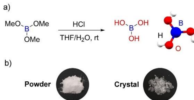
Abbildung 5-8. a) Synthese von Borsäure aus \text{B}(\text{OMe})_3 . b) Fotografien von BA als gemahlene Pulver und als Kristalle, aufgenommen bei Tageslicht. Das gemahlene Pulver behält die Kristallinität.
