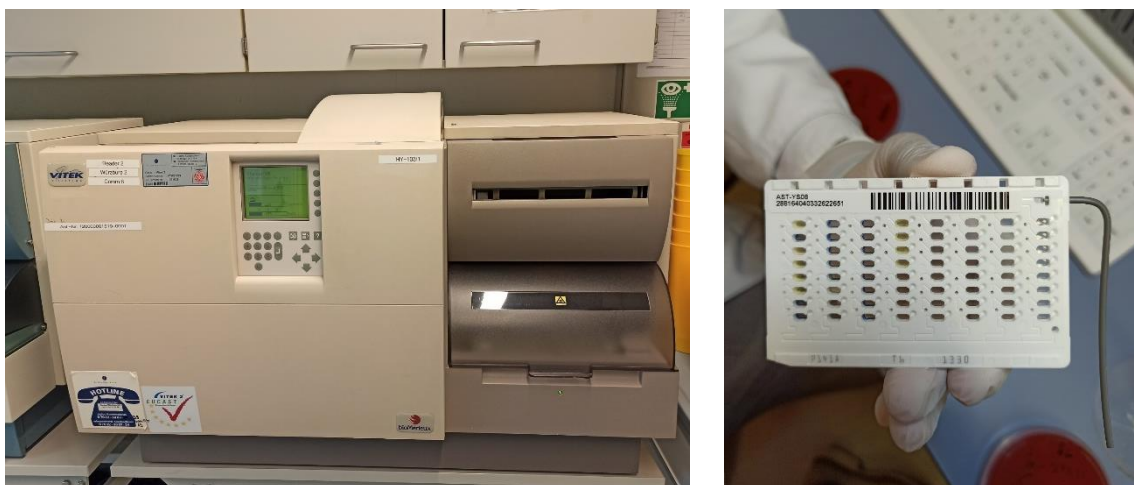
Abb.4: Automatisches VITEK2-Testsystem (bioMérieux, Marcy-l'Étoile, Frankreich) mit Inkubator-Karussell (links) zur Aufnahme und Bebrütung von AFST-YS08 Resistenzkarte (rechts).
