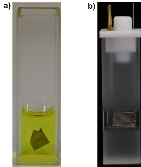
Abbildung 3.3.: a) SWNT-Film auf Kuvetteninnenseite mit \text{AuCl}_3 -Lösung. b) SEC-Küvette.
