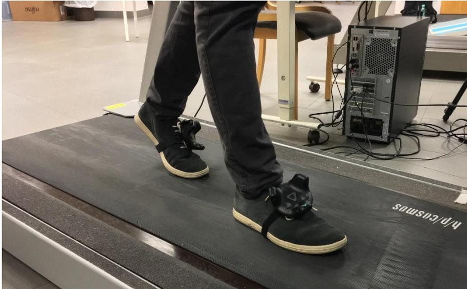
Abbildung 8. Befestigungskonstruktion der Tracking-Sensoren für die Füße mit Klettverschlusslösung.
