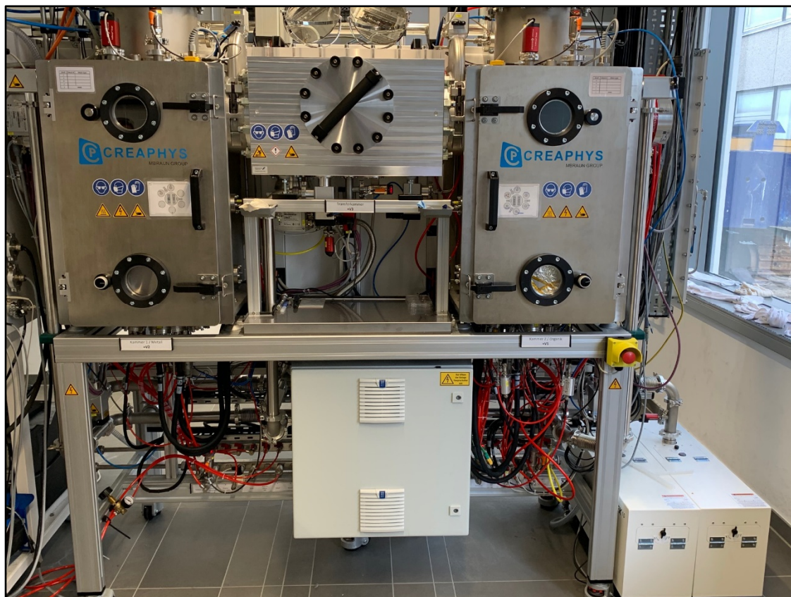
Abbildung 135: Foto der Aufdampfanlage OPTIvap-XL zur Fertigung von organischen Bauteilelementen.
