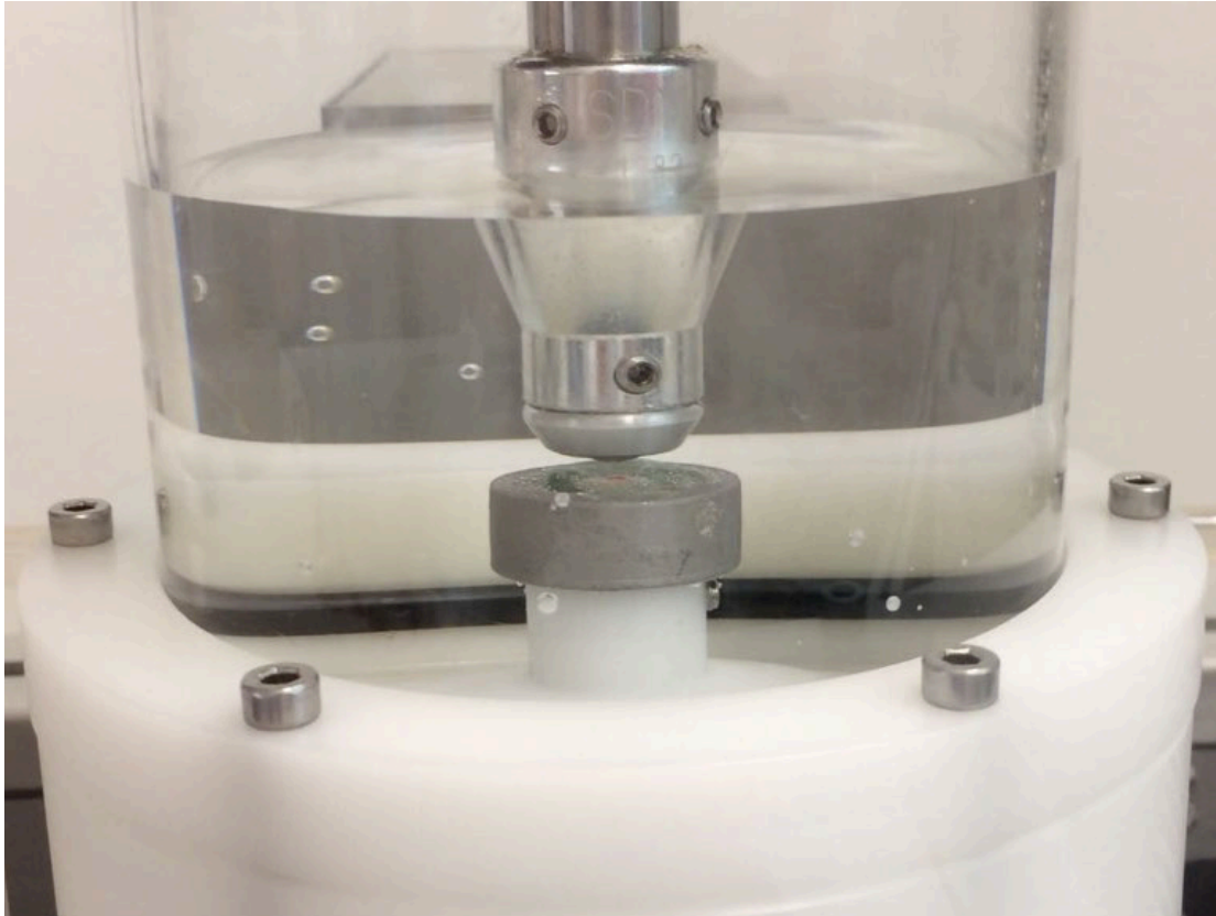
Abbildung 21: Probe in der Kammer des Kausimulators
