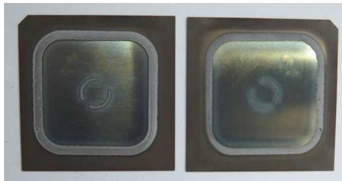
Abbildung 5.2.: Aufgebrochene Q50–Probe: Innerhalb der Glaslotkontur nicht oxidiert (metallisch glänzend), außen oxidiert (matt).
