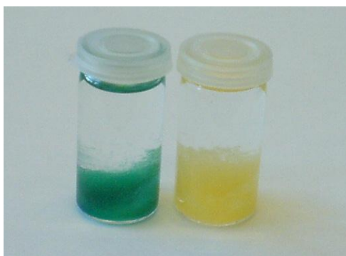
Abb. 4.43 Positiver (links) und negativer (rechts) Malachitgrüntest
