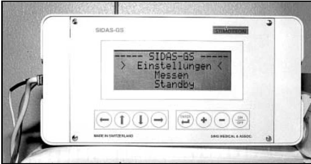
Abbildung 29: SIDAS-GS-Verstärker (links im Bild ist der Anschluss des Datenkabels aus Abb. 27 sichtbar).
