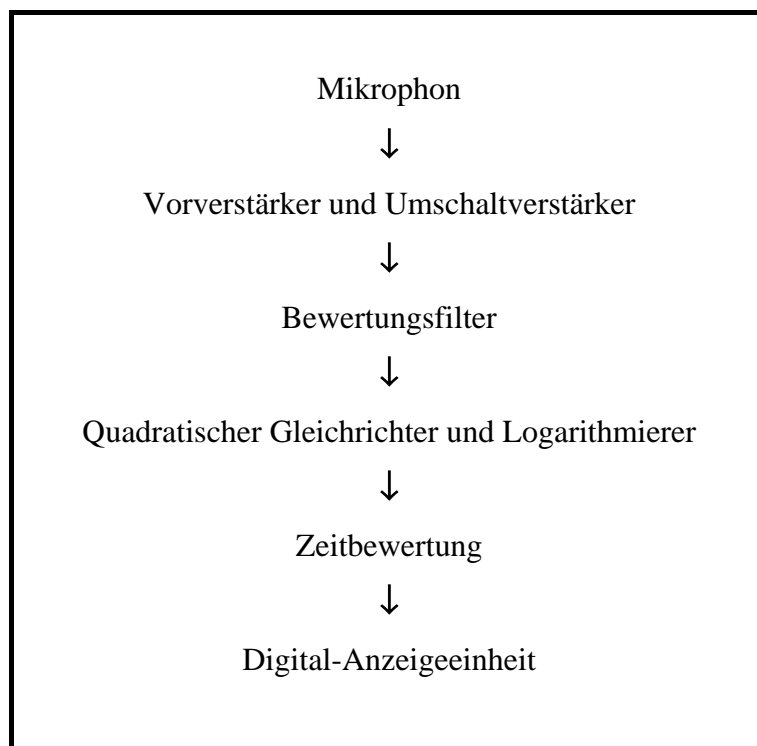
Abbildung 5: Aufbau-Blockschaltbild Schallpegelmessgerät SPM 130.
