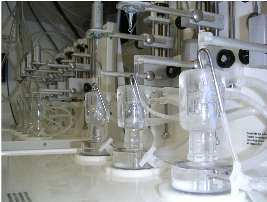
Abbildung 4: Organbadapparatur mit acht parallelen Organkammern, zentraler Pufferversorgung und Begasung.
