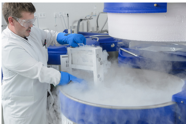
Stammzellen werden im Reinraumlabor unter hochsterilen Bedingungen tiefgefroren und in speziellen Stickstofftanks bei Temperaturen unter -140 Grad Celsius gelagert. (Bild: UKW / Daniel Peter)
