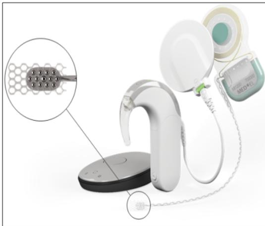
Abbildung 3: Aktuelles ABI der Firma MED-EL Modell Synchrony
