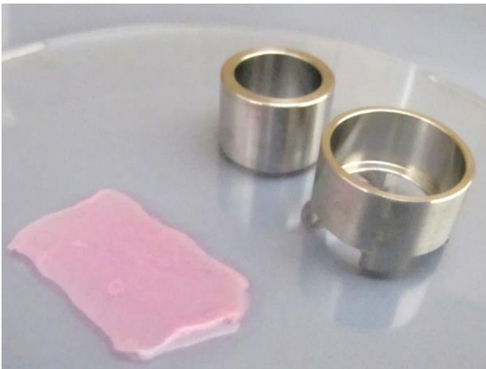
Abbildung 3: SISmuc und demontierte Zellkrone
