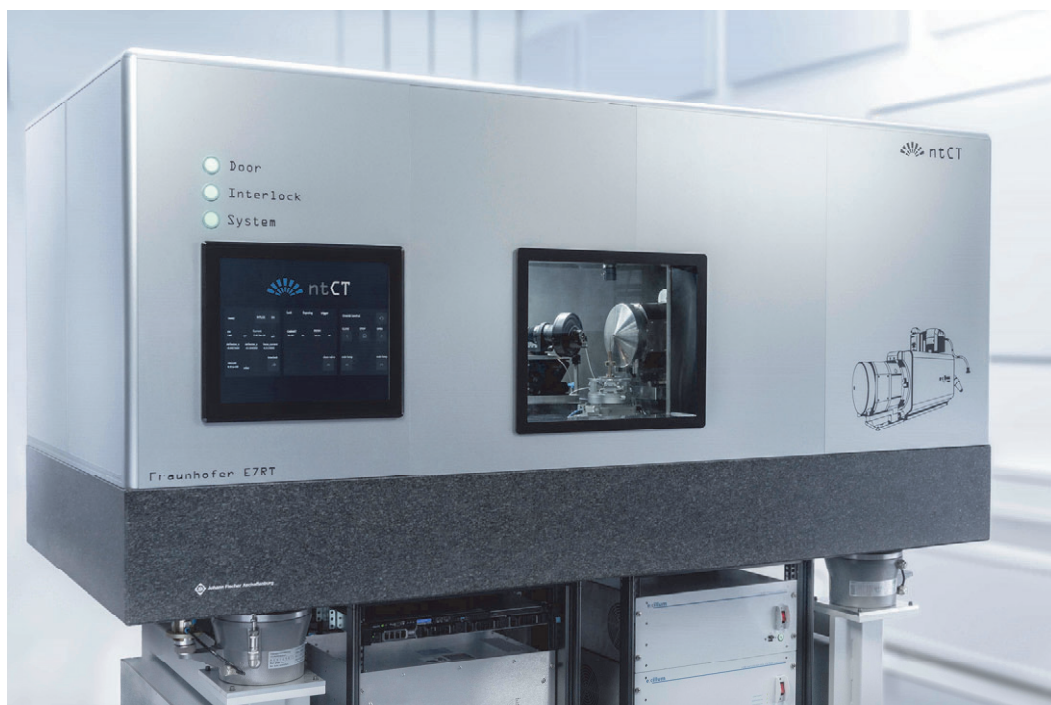
Abb. 5.1 Die ntCT ist eine CT-Anlage zur hochauflösenden Materialcharakterisierung im Labormaßstab.
