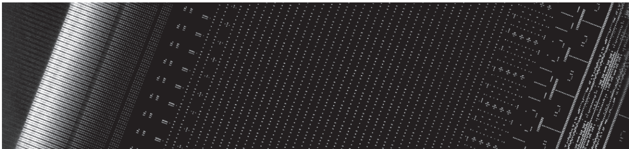
Abb. 6.3 Das horizontales Schnittbild aus der Rekonstruktion der Halbleiterprobe gemittelt über 40 Schnittbilder aus der Speicherschicht zeigt eine detaillierte und rauscharme Darstellung der Metallkontakte.
