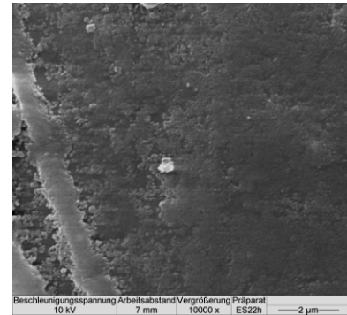
Abb. 5.113: REM; Vergr. 10000x; DATEM/0,2% SIPERNAT ® 22S; Turbula ® ; 42 UpM; 120 min
