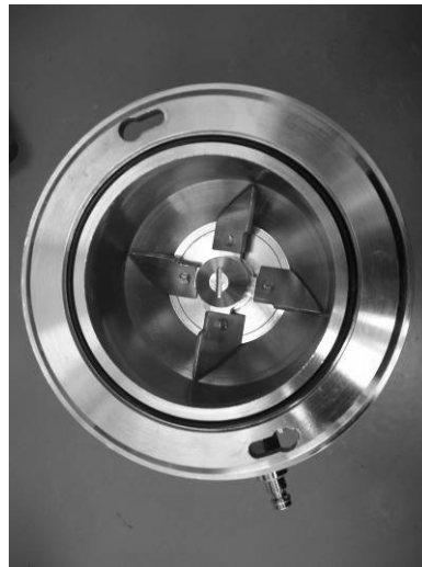
Abb. 4.16: Mischbehälter mit Schereinsatz (Aufsicht)
