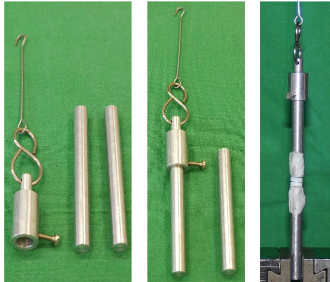
Abbildung 24: Die Einzelteile der Versuchsvorrichtung des Tensile-Tests. Links, Mitte: Die speziell durch Feinmechanik Sauer angefertigten Metallstäbe und die Aufhängevorrichtung. Rechts: Die Einzelteile im fertig aufgebauten Tensile-Test. Zwischen Metallstäben und Knorpelscheiben wurde Fixierpflaster für eine bessere Fixierung und Wiederverwendbarkeit der Stäbe verwendet.
