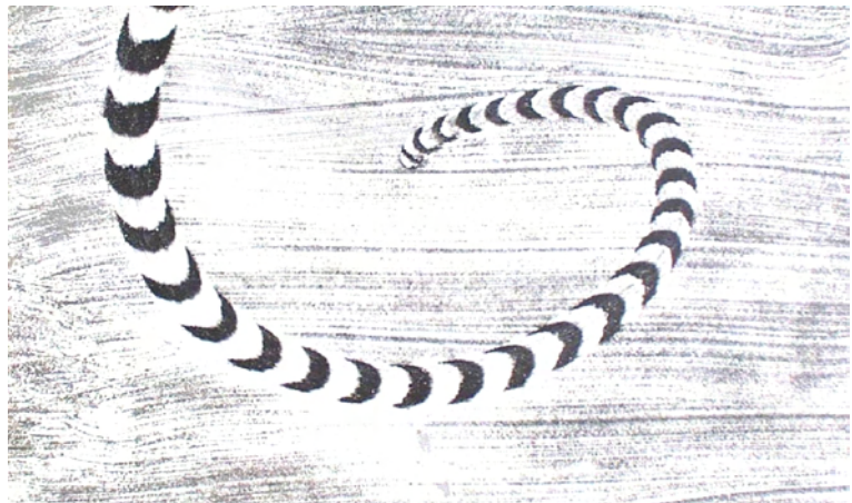
Abb. 5.11: Foto einer Spur auf der Schwefelplatte
