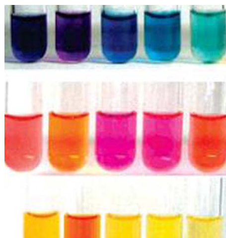
Die Farben verschiedener Metallo-Polyelektrolyte variieren in Abhängigkeit vom Metall-Ion, das sie enthalten. Oben ist Eisen im Spiel, in der Mitte Ruthenium, unten Cobalt. Foto: Dirk Kurth
