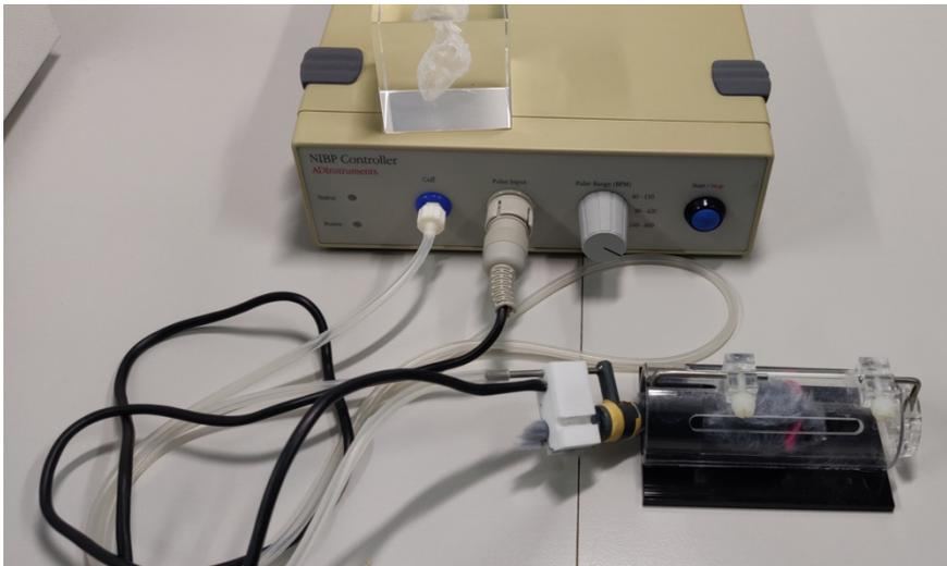
Abb. 4: Versuchsaufbau der nicht-invasiven Blutdruckmessung
