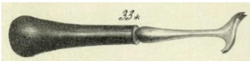
Abbildung 29: *Geissfuss mit doppelter Klaue*<sup>506</sup>
