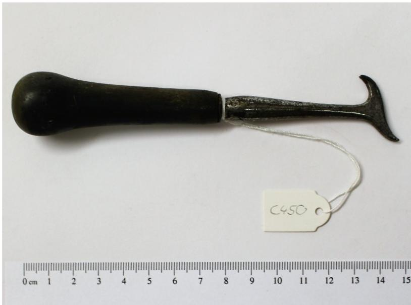
Abbildung 28: C-450: *Geissfuss mit doppelter Klaue*<sup>505</sup>, aus Ebenholz gefertigter Griff, welcher nach der Hälfte der Gesamtlänge in einen im Griffstück befestigten Stahlschaft übergeht, an dessen Wirkende befinden sich zwei schnabelförmige Enden, die jeweils in die entgegengesetzte Richtung mit zwei zahnchenförmigen Spitzen mit dreieckiger Aussparung dazwischen gewinkelt zum Stahlschaft stehen
