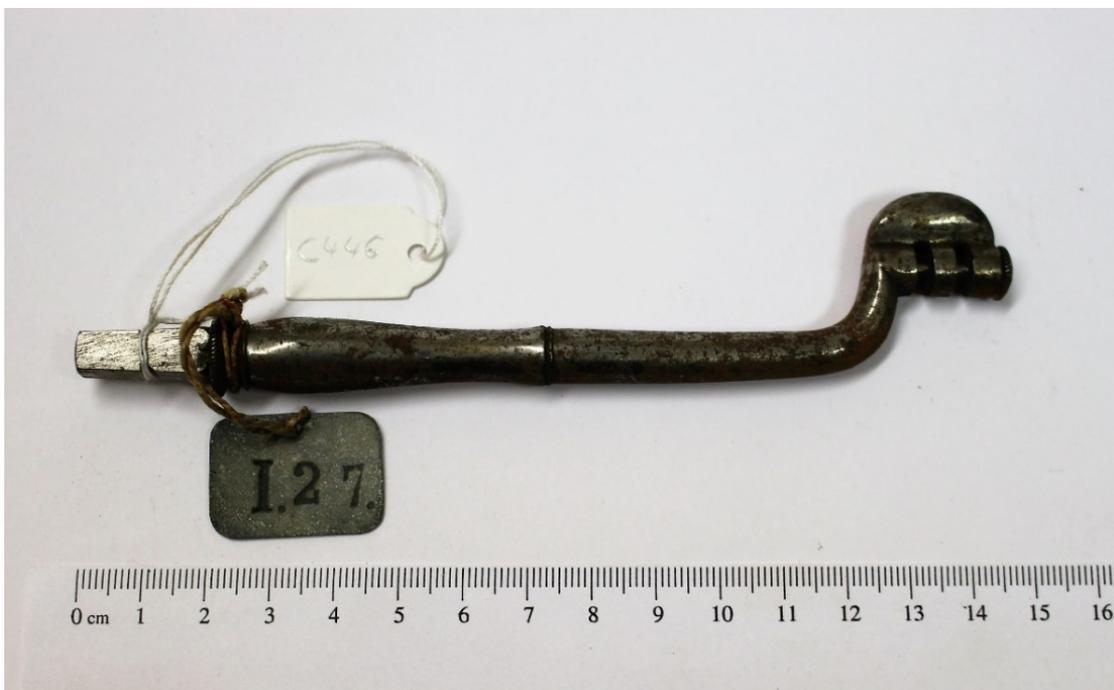
Abbildung 14: C-446: Zahnschlüssel nach Garengéot (ohne Griff)<sup>493</sup> mit rechtwinklig gebogenem Endstück vom geraden stielartigen Stahlschaft abgehend, auf der Hälfte des geraden
