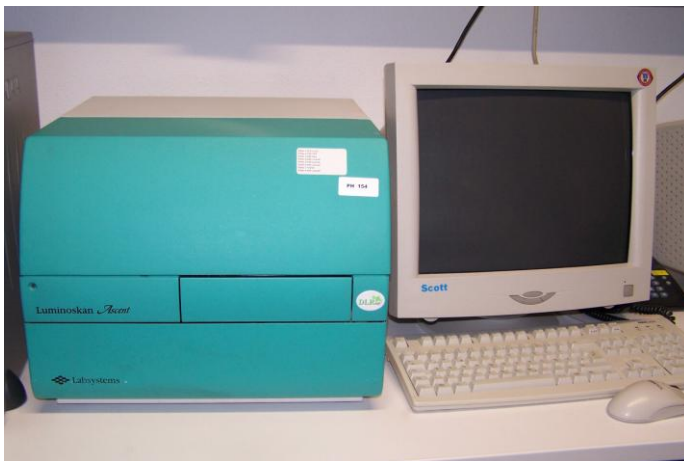
Abb. 2.4.: Luminoskan Ascent ® Photomultiplier mit computergesteuertem Dispensersystem.
