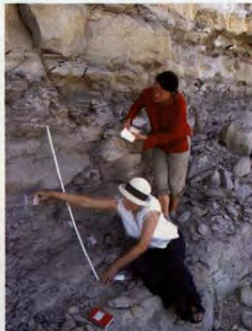
*Kreidezeitlichen Klima-Zyklen auf der Spur: Die sich abwechselnden Schichten aus Kalk und Mergel (oben) in Nordspanien sind 94 Millionen Jahre alt. Zu ihrer Analyse wurde unter anderem die natürliche Gamma-Strahlung im Gelände gemessen (links). Für geochemische Analysen entnahmen die Würzburger Forscher Proben (rechts). Fotos: Wilmsen*
