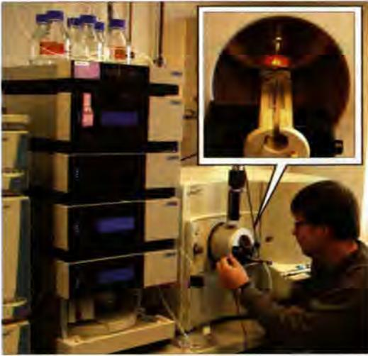
*Protein- und Arzneistoff-Analytik in der Pharmazeutischen Biologie: Nach chromatographischer Trennung gelangen die Zielmoleküle in eine Ionisationskammer (Bildauschnitt), wo sie für ihren Flug in den Massenspektrometer präpariert werden.*
