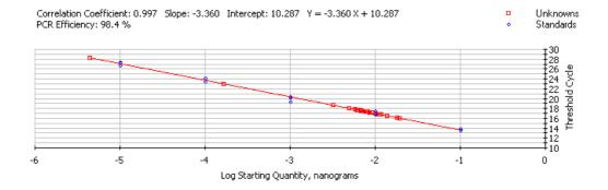
**Abb. 2.2: Beispiel einer Standard-Kurve**: Die Kurve wurde erstellt durch Verdünnung einer Standard-DNA (blaue Markierung). Die rote Markierung gibt die Messwerte für das HHG GAPDH im Hirnstamm der Maus an.
