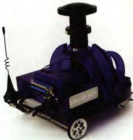
Abb. 4: Der *Drosophila-Orientierungsroboter (Dro-o-boT)* besitzt dank einer nach oben gerichteten Kamera mit Fischaugenobjektiv eine ähnliche Rundumsicht wie die Fliege. Die Kamerabilder werden mit Algorithmen verarbeitet, wie sie ähnlich auch im Fliegengehirn realisiert sein müssen. Bild: Mronz
