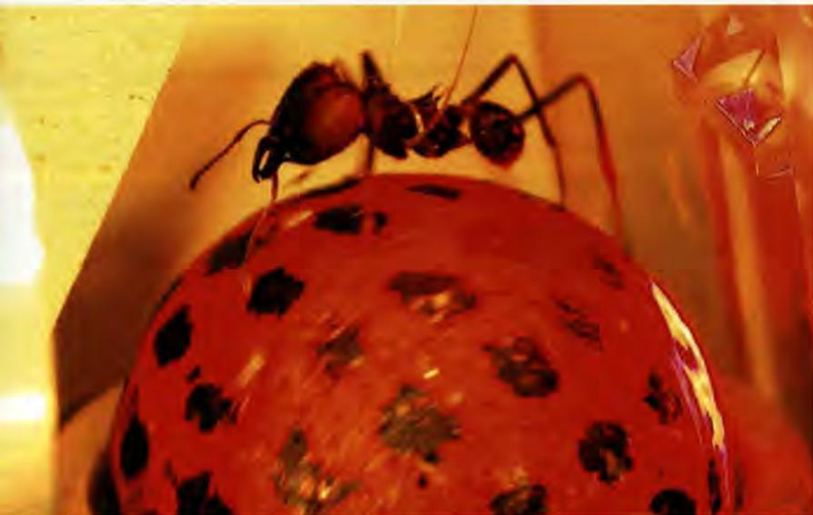
*Abb. 1: Die Laufreaktionen einer Blattschneiderameise auf Duftreize werden elektronisch über die Rotation eines Styroporballs, der auf einem Luftstrom schwebt, registriert.*
