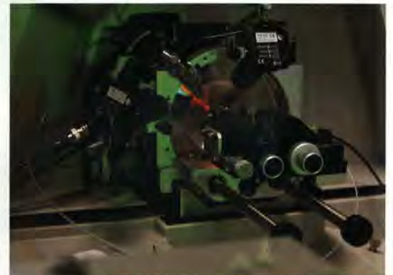
Beginn der Flugreise: Eine Nano-Electrospray-Ionenquelle. Foto: Rudolf-Virchow-Zentrum
