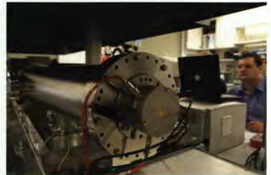
In diesem Massenspektrometer müssen die Peptid-Ionen eine Flugstrecke von vier Metern zurücklegen.
