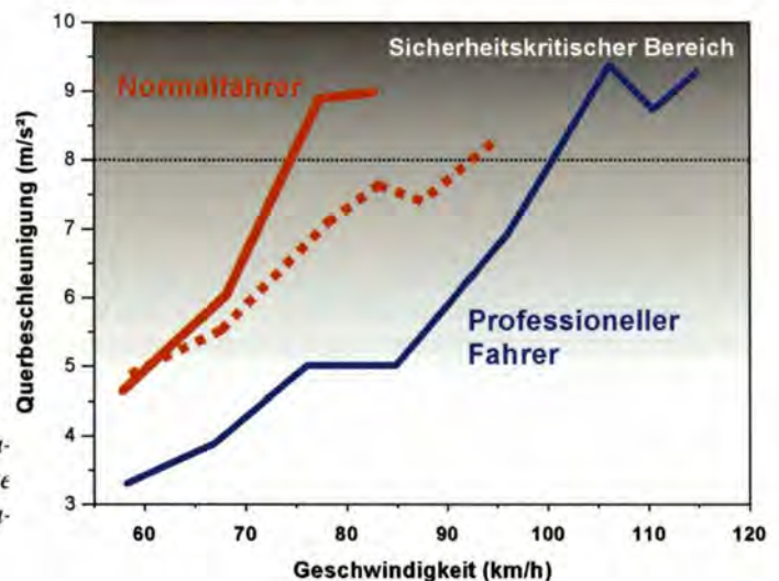
Abb. 2: Querbeschleunigungsmaximalwerte in einem Ausweichmanöver.
