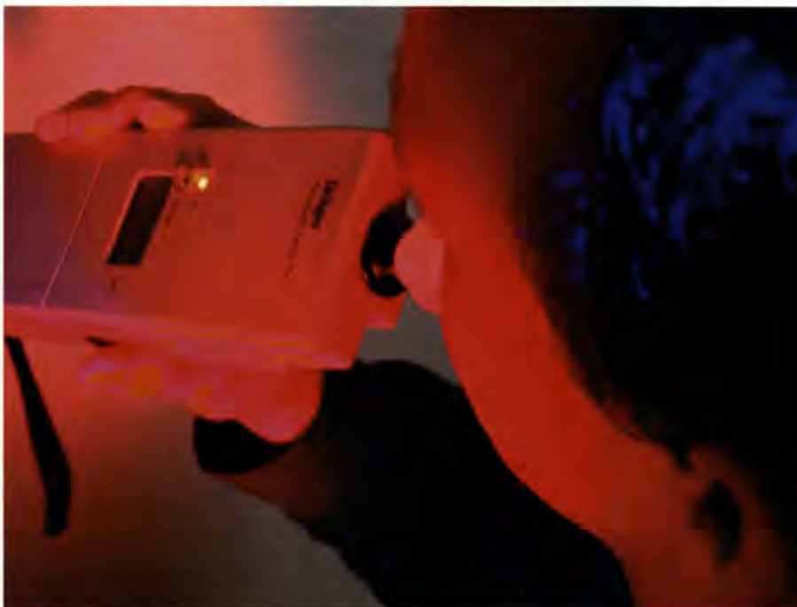
Abb. 2: Atemalkoholmessung mit dem Dräger Alcotest 7410.
