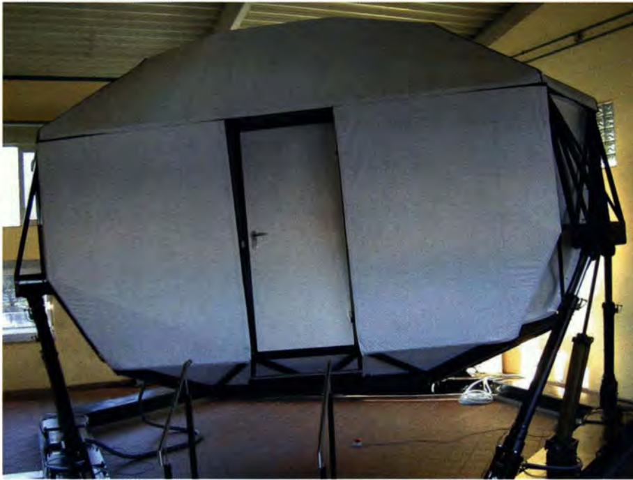
Abb. 1: Fahrzeugkabine mit elektro-pneumatischem Bewegungssystem.
