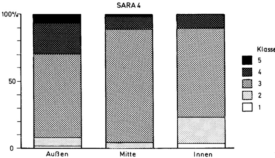
Fig. 38: Probe Nr. Sara 4: Korrosionsbeanspruchung der Quarzkörner in verschiedenen Probenbereichen
