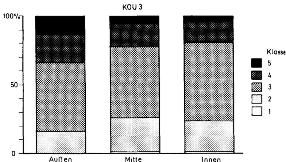
Fig. 47: Probe Nr. Kou 3: Korrosionsbeanspruchung der Quarzkörner in verschiedenen Probenbereichen
