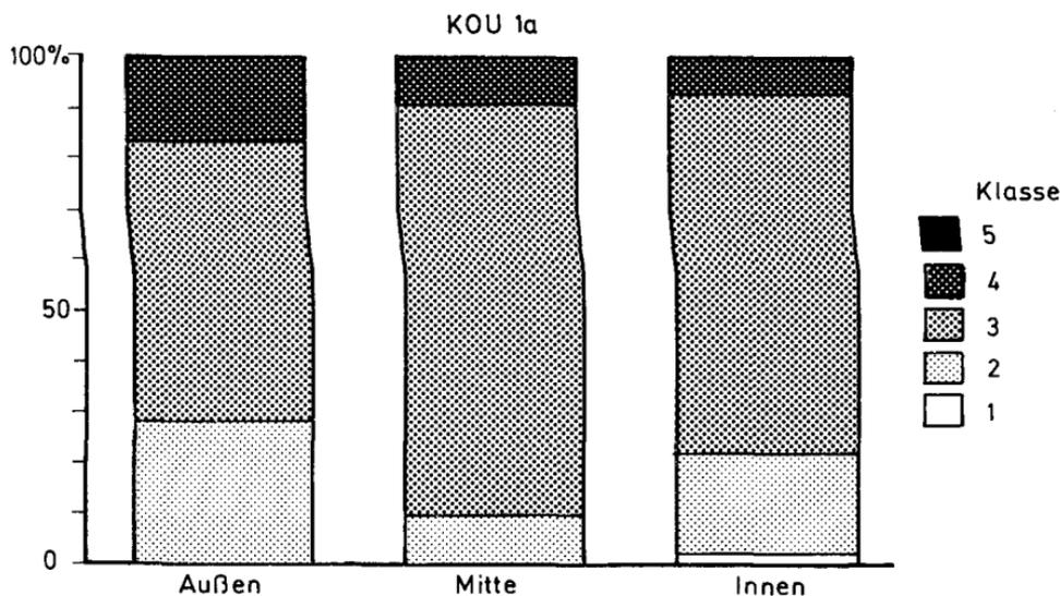
Fig. 45: Probe Nr. Kou 1a: Korrosionsbeanspruchung der Quarkörner in verschiedenen Probenbereichen
