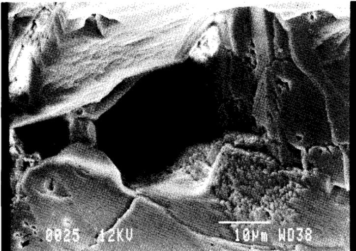
Abb. 13: Stark korrodierte Quarzkörner im krustennahen Bereich (Probe Nr. Ori)
