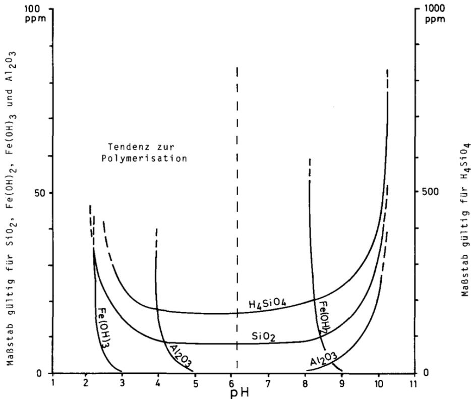
Fig. 36: Löslichkeitsdiagramm für SiO<sub>2</sub>, H<sub>4</sub>SiO<sub>4</sub>, Fe(OH)<sub>2</sub>, Fe(OH)<sub>3</sub> und Al<sub>2</sub>O<sub>3</sub> bei 25°C in Abhängigkeit vom pH-Wert (nach: KRAUSKOPF, 1956; WIRTHMANN, 1987)
