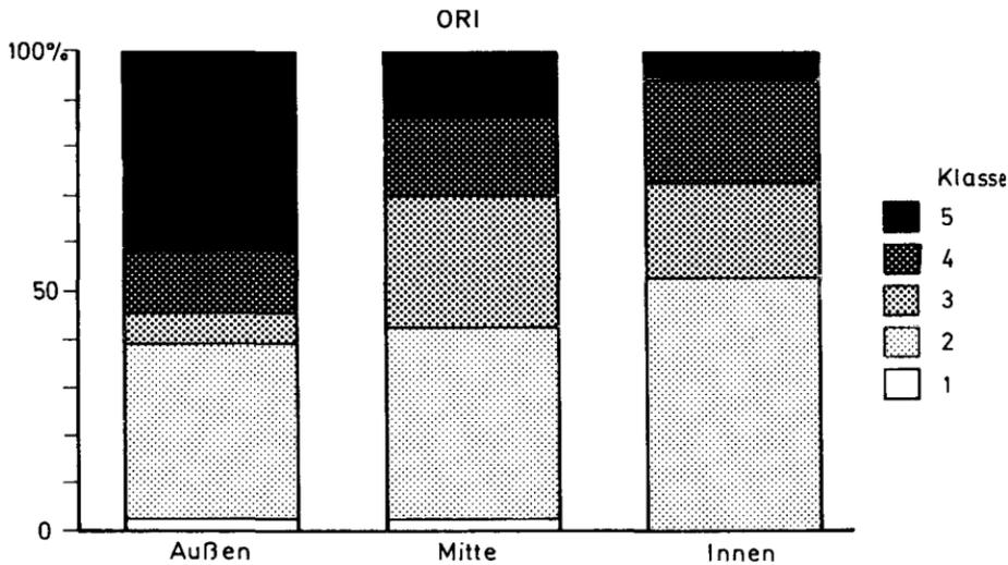
Fig. 37: Probe Nr. Ori: Korrosionsbeanspruchung der Quarzkörner in verschiedenen Probenbereichen (nach BURGER & LANDMANN, 1988)
