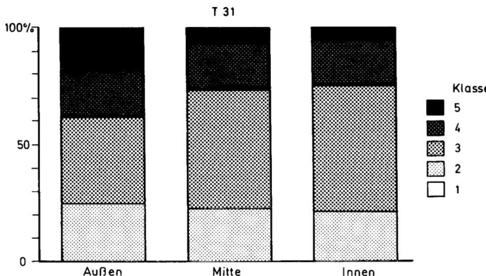
Fig. 43: Probe Nr. T 31: Korrosionsbeanspruchung der Quarzkörner verschiedenen Probenbereichen
