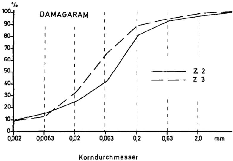
Fig. 58: Korngrößen-Summenkurven von Verfüllungsproben aus dem Damagaram
