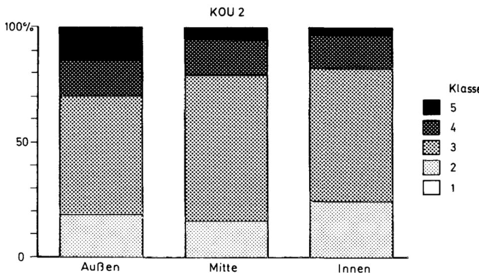
Fig. 46: Probe Nr. Kou 2: Korrosionsbeanspruchung der Quarzkörner in verschiedenen Probenbereichen
