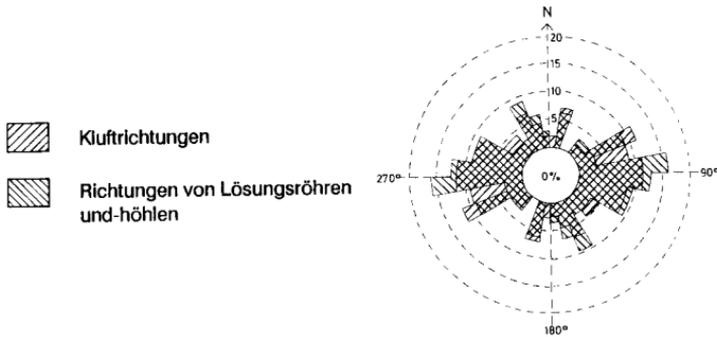
Fig. 18: Klufrichtungen und Richtungen von Lösungsröhren und -höhlen an der südlichen Stufe von Bilma
