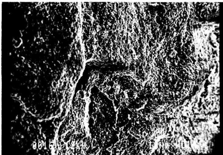
Abb. 15: REM-Aufnahme von flächenhafter Quarzausfällung auf einem Quarzkorn (Probe Nr. Chem. 3)
