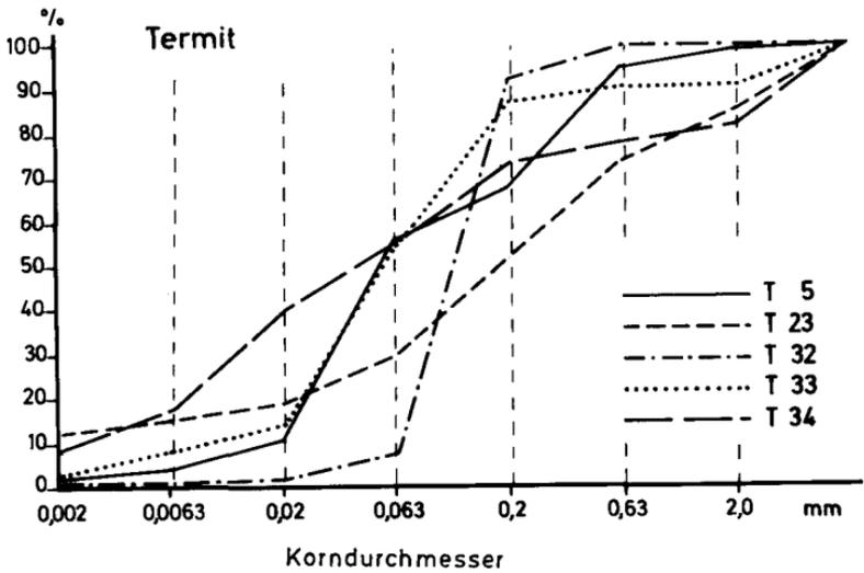
Fig. 55: Korngrößen-Summenkurven von Verfüllungsproben aus dem Massif de Termit
