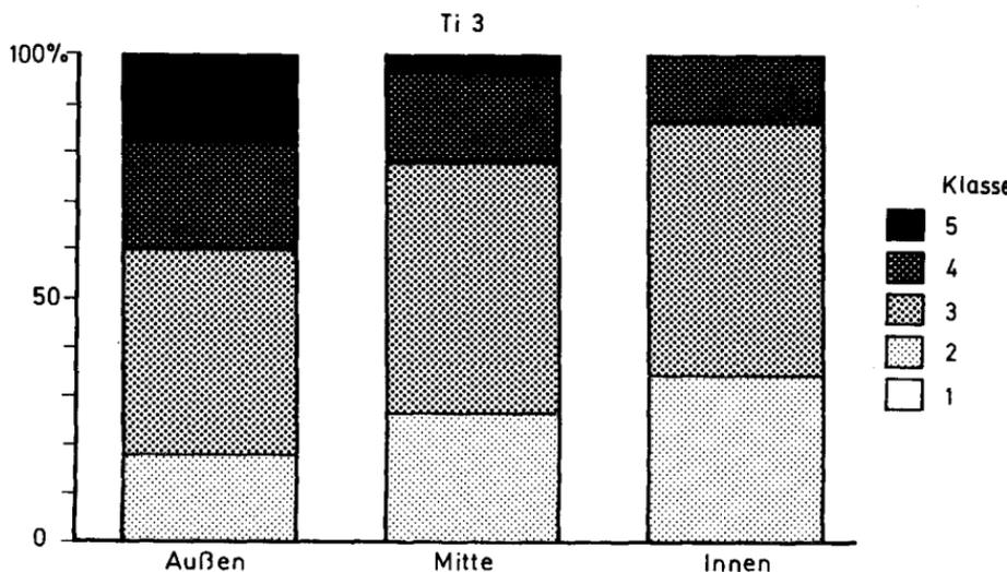
Fig. 52: Probe Nr. Ti 3: Korrosionsbeanspruchung der Quarzkörner in verschiedenen Probenbereichen
