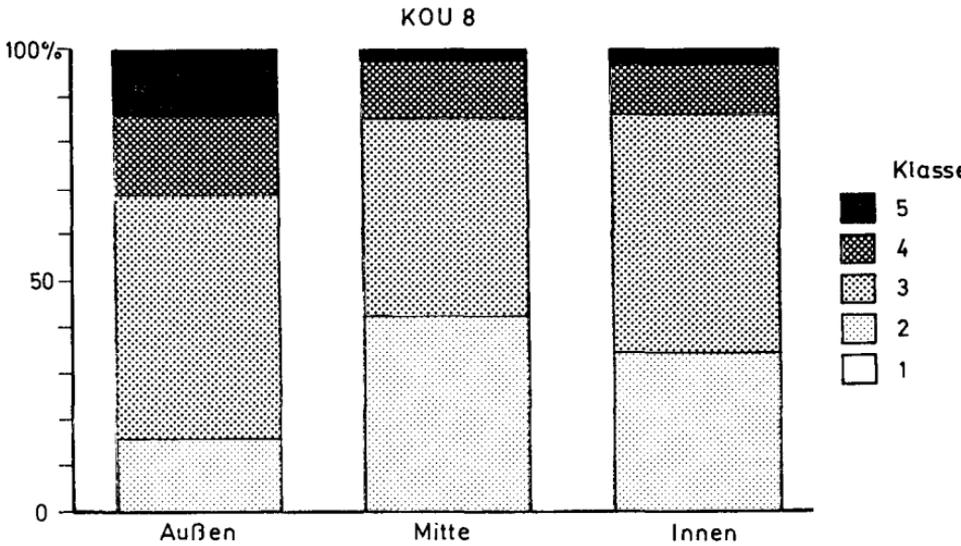
Fig. 49: Probe Nr. Kou 8: Korrosionsbeanspruchung der Quarzkörner in verschiedenen Probenbereichen
