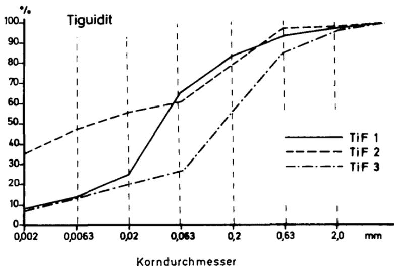
Fig. 57: Korngrößen-Summenkurven von Verfüllungsproben von der Stufe von Tiguidit
