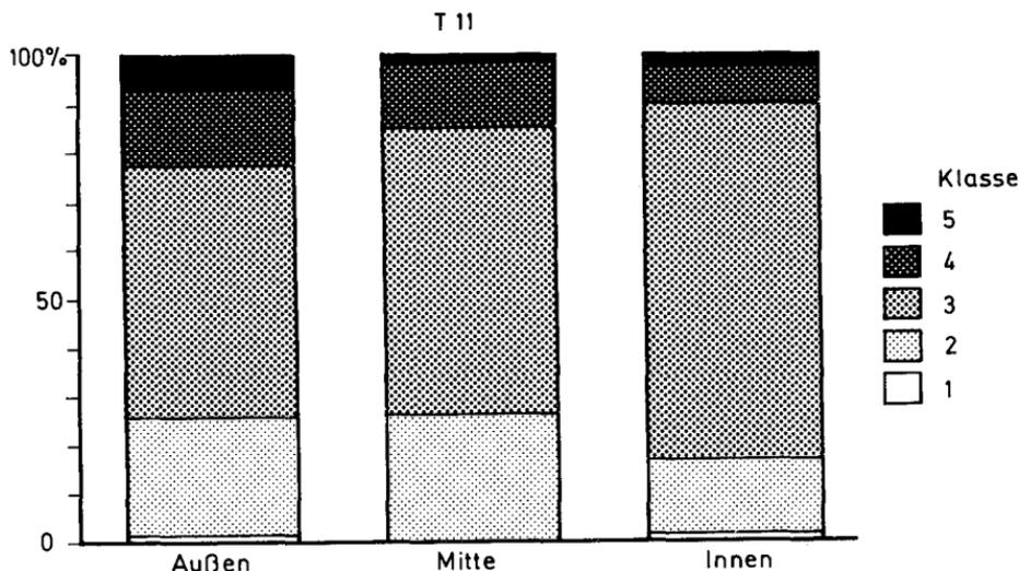
Fig. 41: Probe Nr. T 11: Korrosionsbeanspruchung der Quarzkörner in verschiedenen Probenbereichen
