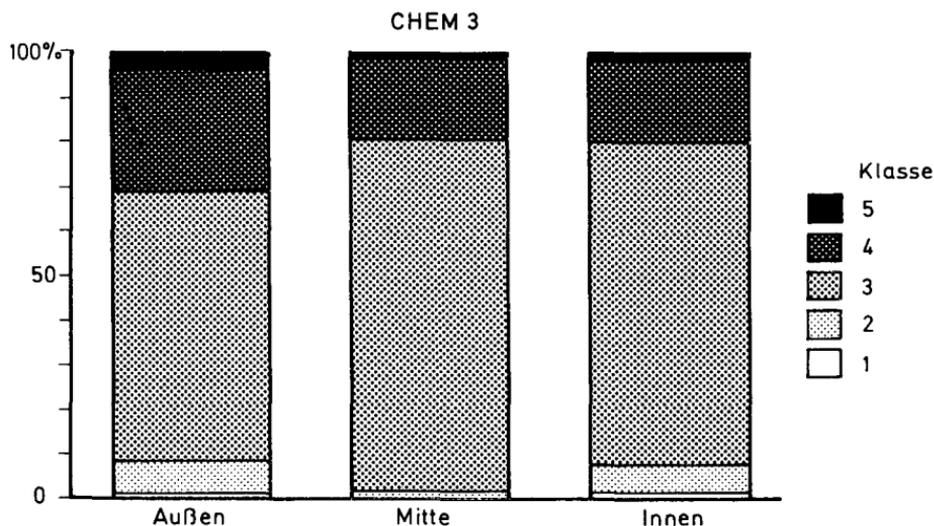
Fig. 40: Probe Nr. Chem 3: Korrosionsbeanspruchung der Quarzkörner in verschiedenen Probenbereichen
