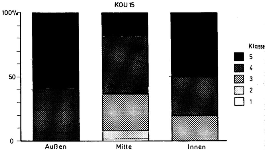
Fig. 53: Probe Nr. Kou 15: Korrosionsbeanspruchung der Quarzkörner in verschiedenen Probenbereichen
