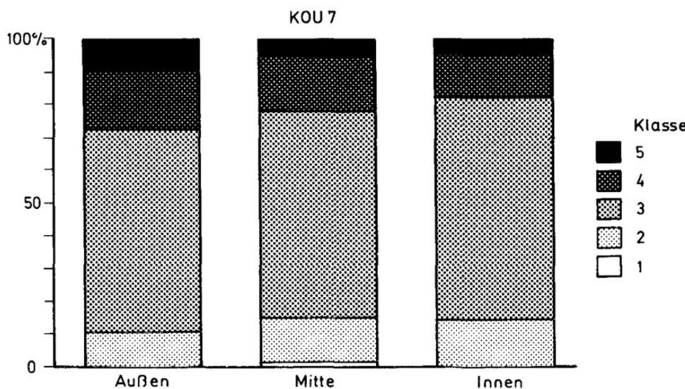
Fig. 48: Probe Nr. Kou 7: Korrosionsbeanspruchung der Quarzkörner in verschiedenen Probenbereichen
