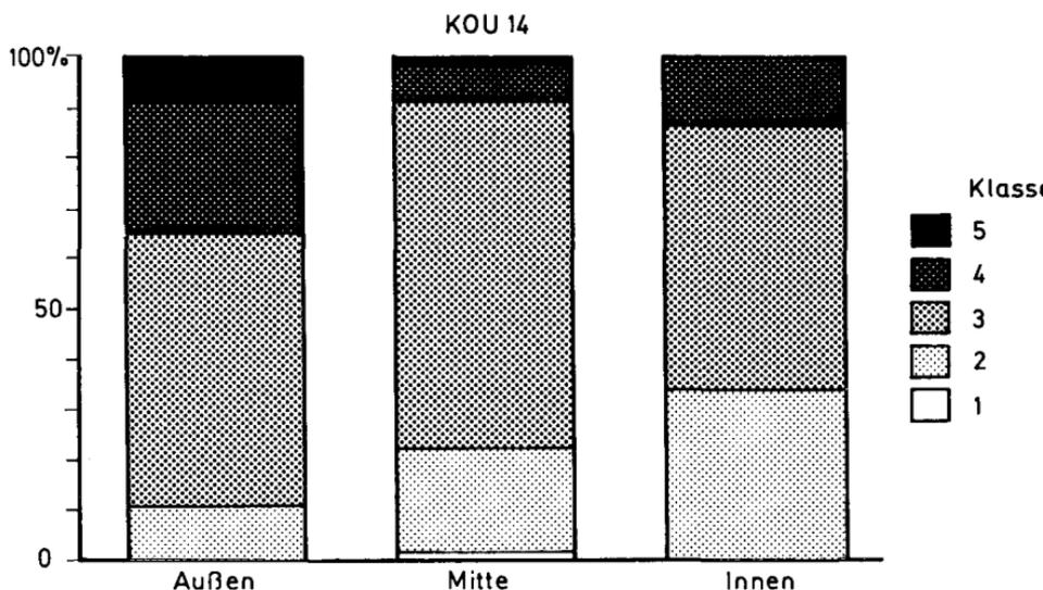
Fig. 51: Probe Nr. Kou 14: Korrosionsbeanspruchung der Quarzkörner in verschiedenen Probenbereichen
