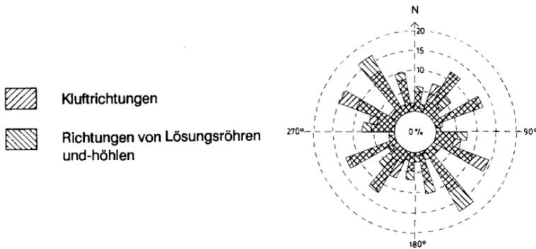
Fig. 24: Klufrichtungen und Richtungen von Lösungsröhren und -höhlen im Massif de Termit (zentraler Teil)
