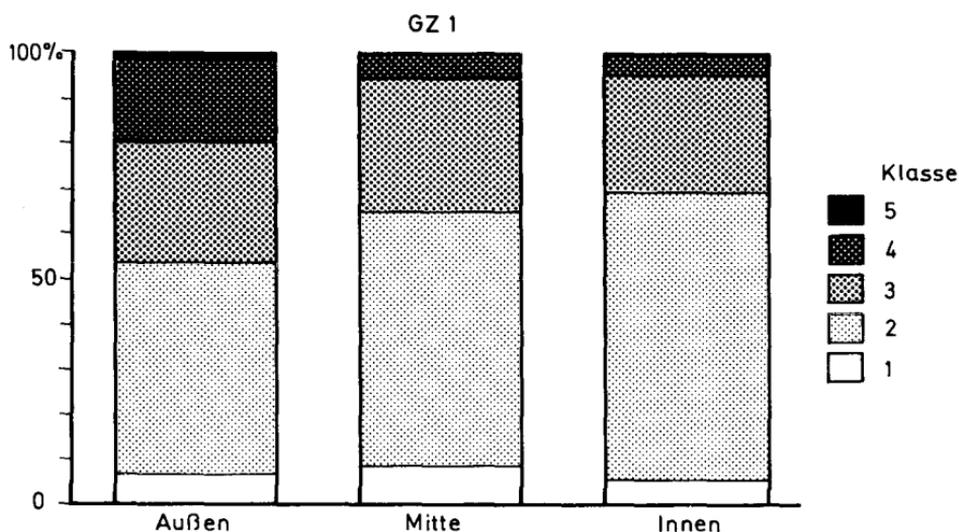
Fig. 39: Probe Nr. GZ 1: Korrosionsbeanspruchung der Quarzkörner in verschiedenen Probenbereichen
