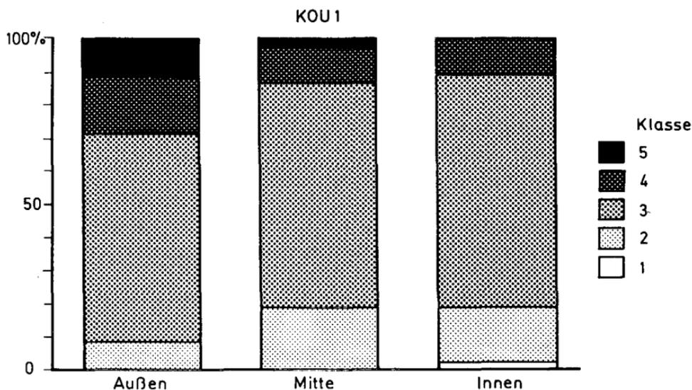
Fig. 44: Probe Nr. Kou 1: Korrosionsbeanspruchung der Quarzkörner in verschiedenen Probenbereichen
