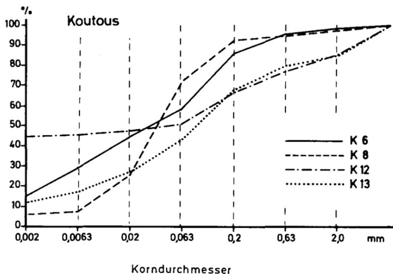
Fig. 56: Korngrößen-Summenkurven von Verfüllungsproben aus dem Massif de Koutous
