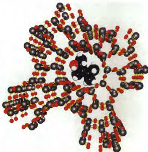
Abb. 1: Blick in die Gitterstruktur eines Zeolithen. Zeolithe sind Silicate, die als „Molekularsiebe“ (z.B. als Wasserenthärter in Waschmitteln) eingesetzt werden. Sie eignen sich aber auch als Katalysatoren für Oxidationsreaktionen, wenn einzelne Gitteratome durch katalytisch aktive Metalle (z.B. durch Titan) ersetzt werden. Dabei wirken sie zugleich als Filter, denn nur Substanzen, die (wie auf dem Bild dargestellt) in die Poren hineinpassen, können selektiv umgesetzt werden. Quelle: SFB 347, Blick 2/96
