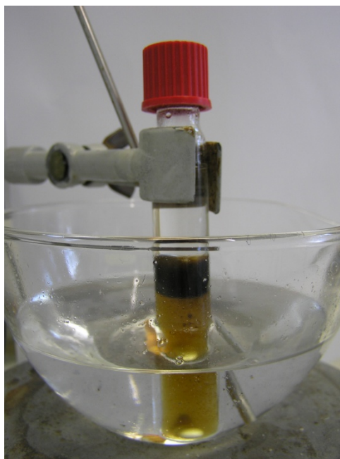
Abb. 92: Fotografie der Reaktionslösung der Dimerisierungsreaktion: Von oben nach unten: Toluen-, Misch- und Wasser-Phase.
