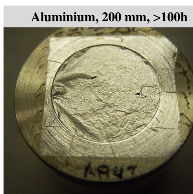
Abbildung 3.8: Aluminium-Filter mit einer Dicke von 200 nm nach über 100 Stunden Bestrahlung durch ein Stickstoff-LIP bei einem Abstand von 200 mm (links) und eine REM-Aufnahme (rechts) bei 8400-facher Vergrößerung und 30 kV Beschleunigungsspannung [95].
