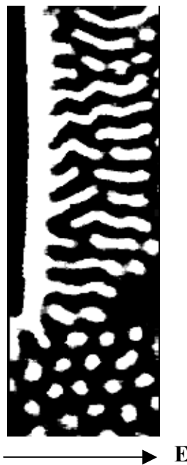
Abbildung 8.1: Die Ausrichtung der Streifen bei einer Feldstärke von ca. 0,5 V/mm ist parallel zum Feldvektor. Der Pfeil zeigt die Orientierung des elektrischen Feldes an [132].
