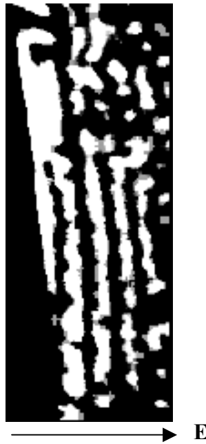
Abbildung 8.2: Bei einer Feldstärke von 1 V/mm ist die Ausrichtung der Streifen senkrecht zum angelegten E-Feld. Der Pfeil zeigt die Orientierung des elektrischen Feldes an [132].
