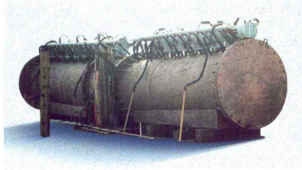
Abb. 3: Detonationsreaktor mit einem Volumen von 100 \text{ m}^3 für die großtechnische Herstellung von Nanodiamant (mit freundlicher Genehmigung der Fa. ALIT (Zhitomir, Ukraine)). [27]
