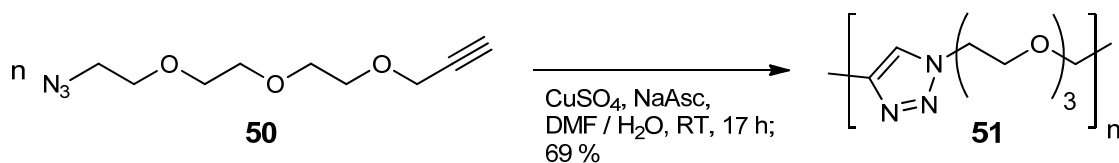
Abb. 43: Click-Polymerisation des Azid- und Alkin-terminierten Monomers 50 .
