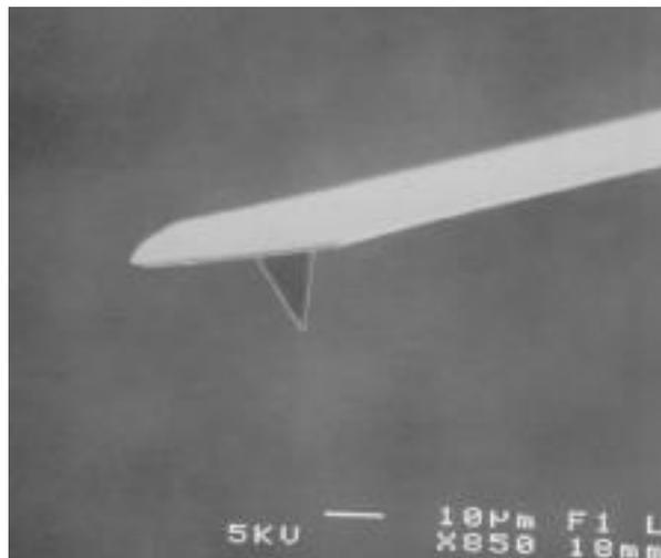
**Abbildung 19:** Rasterelektronenmikroskopische Detailaufnahme einer Silicium-Cantileverspitze
