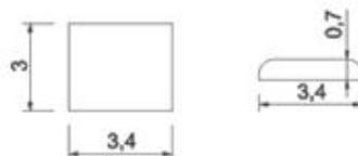
Abbildung 14: Konstruktionsplan der Fixiermodule
