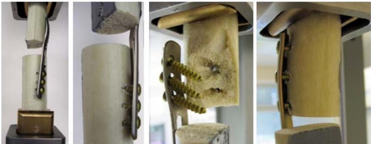
**Abbildung 24:** Proben nach Testung im Ausrissversuch mit proximaler und distaler Verschraubung
