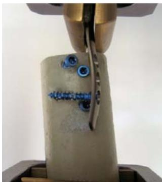
**Abbildung 47:** Versagen des Implantatdesigns 4 im biomechanischen Vorversuch
