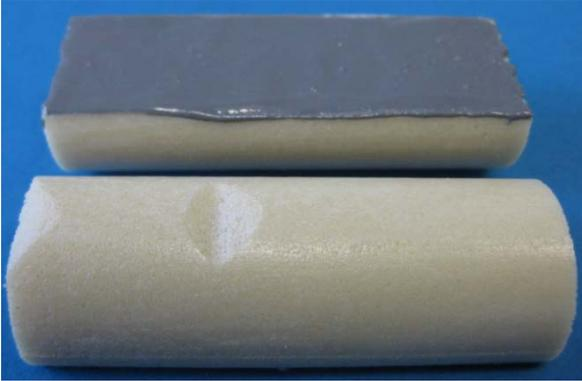
**Abbildung 12:** Osteoporose simulierender Kunstknochen (Radius: 12 mm, Länge 67 mm) mit proximaler Malleolenkontur.
