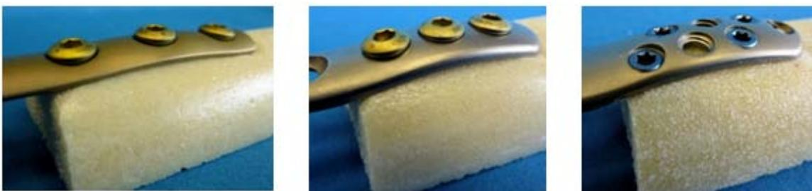
**Abbildung 9:** Vergleichende Darstellung der Schraubenauftragung am Implantat
