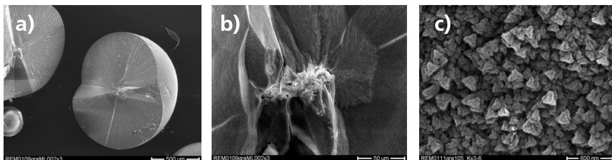
Abbildung 6.4-2: a) REM-Aufnahme eines Mineralisationsprodukts aus poly-AAm-AC nach 28 Tagen Mineralisationsdauer, b) Detailaufnahme des mittleren Bereichs der sphärischen Mineralisationsprodukte, c) trigonale Strukturen auf der Oberfläche.
