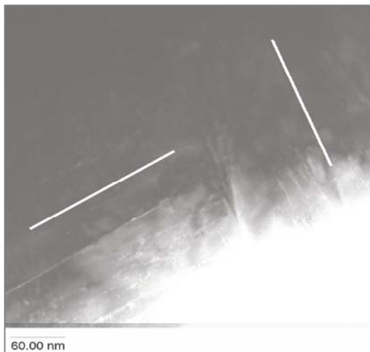
Abbildung 6.1-7: TEM-Aufnahme einer ionengedünnten Probe, die die Orientierung der Verwachsung ist hervorgehoben.
