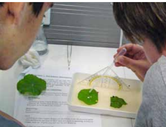
Schüler machen Experimente zum Lotus-Effekt: Wie schnell rollen Wassertropfen von Blättern herab? Bei der Kapuzinerkresse (links), die einen ausgeprägten Lotus-Effekt aufweist, passiert das wesentlich schneller als bei einem Buchenblatt. (Foto Franziska Wiegand)
