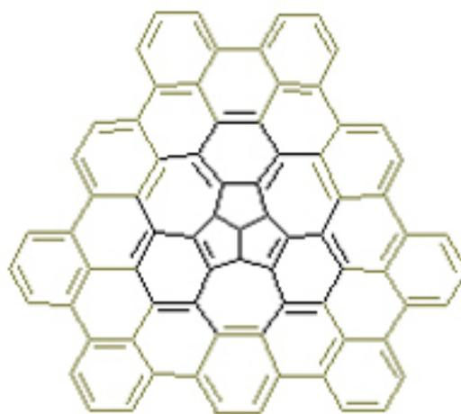
*Graphengitter mit einem so genannten Punktdefekt, der aus drei Fünfringen besteht. Ein solches Strukturelement haben Würzburger Chemiker synthetisiert.
