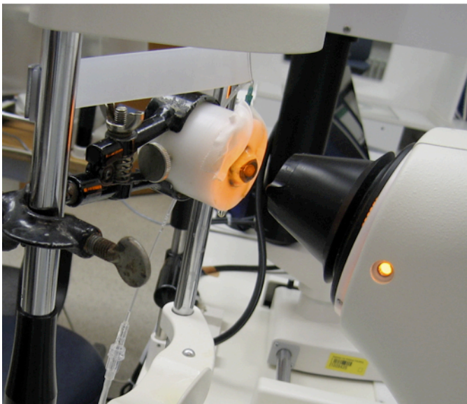
Abbildung 16: Messung der Refraktion mit dem Videokeratographen Keratron-Scout
