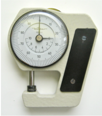
Abbildung 11: Dickenmessgerät J15 (Fa. Käfer, Villingen-Schwenningen, Deutschland)
